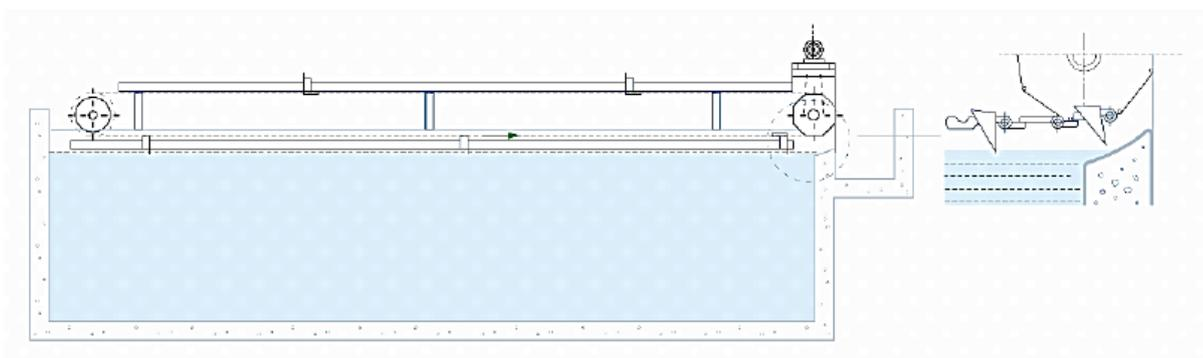
Система сбора плавающих веществ для скребковой системы:
