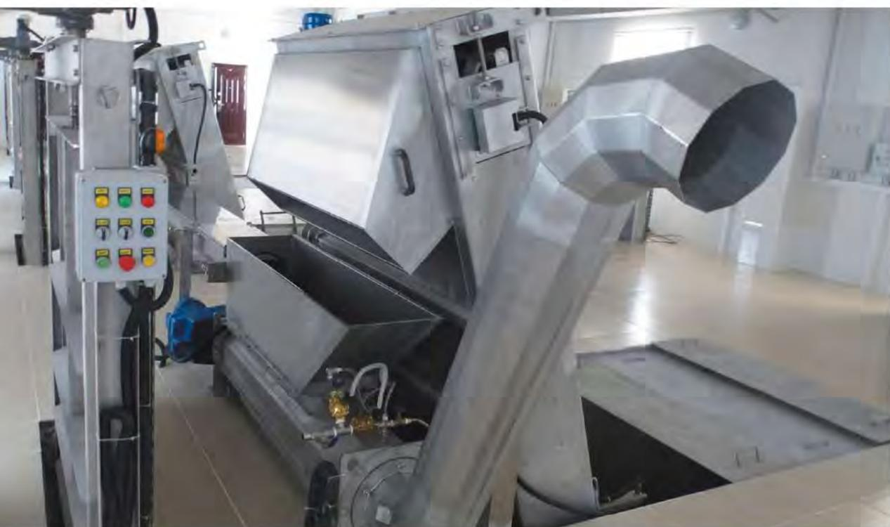
**Максимальная высота выгрузки до 5000 мм под углом до 45°.**
