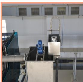
Флокулятор из нержавеющей стали с механической мешалкой. Частота вращения мешалки регулируется, что позволяет произвести качественное смешение осадка и раствора флокулянта, минимизировать затраты на реагенты.
