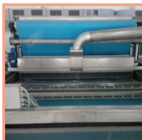
Лопастной автоматический питатель, а также ворошители в зоне гравитационного обезвоживания. Позволяют равномерно распределять осадок по всей ширине полотна вне зависимости от вязкости осадка и улучшить отток фильтрата.
