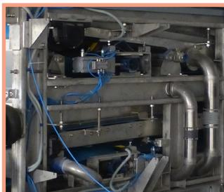
Система позиционирования полотен фильтр-пресса, включающая в себя компрессор, пневматические цилиндры, датчики положения полотен и панель распределения воздуха обеспечивает надежную безаварийную работу оборудования и увеличивает срок службы полотен.
