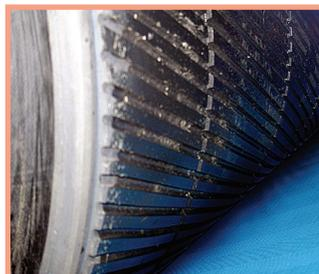
Приводные и главные обезвоживающие валы с резиновым покрытием. В резиновом покрытии главных обезвоживающих валов выполнены канавки спиралевидной формы. Это обеспечивает надежное, без проскальзывания, движение полотен и эффективный отвод фильтрата.
