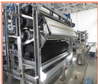
Отжимные валы расположены близко к вертикальной плоскости, каждый вал оборудован лотком сбора фильтрата. Это исключает попадание фильтрата на предыдущий и последующий валы, в отличие от варианта, когда валы располагаются близко к горизонтальной плоскости.
