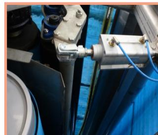
Система дополнительного отжима обеспечивает высокое давление прессования, что позволяет достичь требуемой степени обезвоживания осадка.
