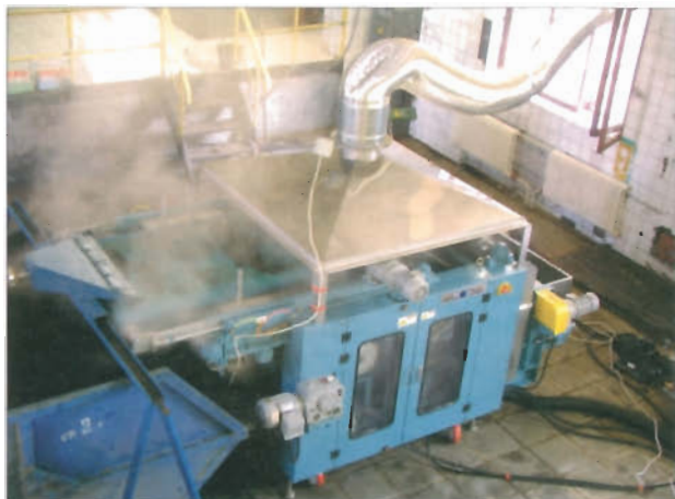
Рис. 3. Установка ELODE® в цехе механического обезвоживания осадков Люберецких очистных сооружений
